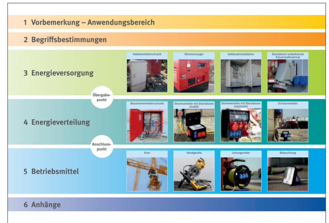
In allen Stromkreisen muss vor dem *Anschlusspunkt* eine Schutzmaßnahme nach VDE 0100-410 angewendet werden.
