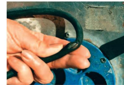
Defekte Leitung eines Leitungsrollers mit Metalltrommel; die Steckdosen erfüllen nicht die Schutzart IP 44.
