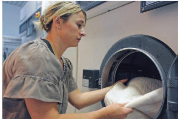
Beim Öffnen der Textilreinigungsmaschine können Reste von Per austreten. Dabei darf der Arbeitsplatzgrenzwert nicht überschritten werden.
