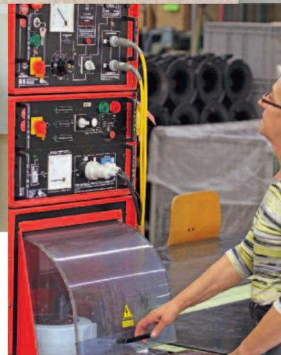
An der Prüfstation für Kabeltrommeln fiel den BG-Mitarbeitern besonders positiv auf, dass die regelmäßigen Prüfungen (nach VDE und BGV A3) durchgeführt wurden und es Betriebsanleitungen für die jeweilige Prüfaufgabe gibt.
