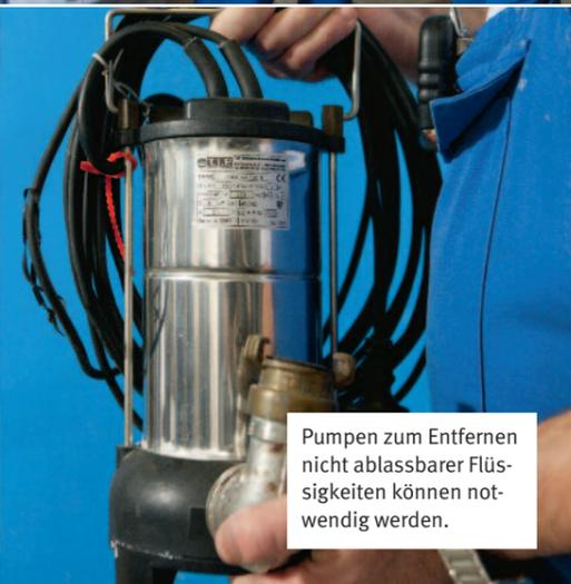
Pumpen zum Entfernen nicht ablassbarer Flüssigkeiten können notwendig werden.
